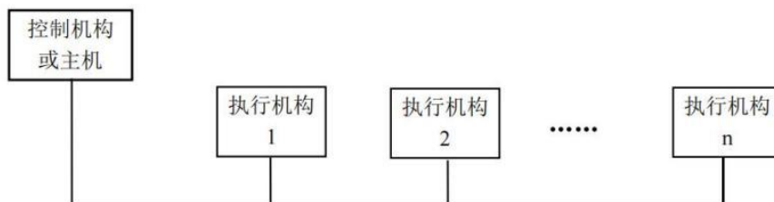
图 6-14 现场总线控制系统
