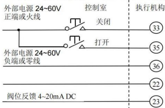
图 6-4 点动式打开/关闭控制, 执行机构可以停在中途任意位置
